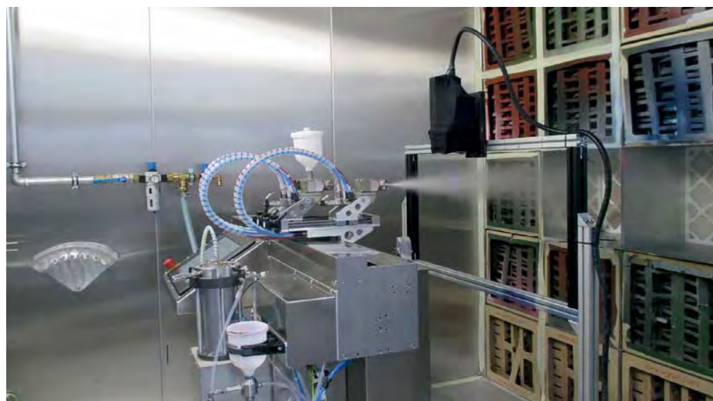
Ein „SpraySpy SS20V125F“ (schwarz, oben rechts) charakterisiert das Spray eines „GunPainter QC 103“ mit einem pneumatischen Zerstäuber Typ „AGMD 514“ mit einer 1,4 mm Düse und einem „C797 Air Cap“. Quelle (zwei Bilder): AOM
