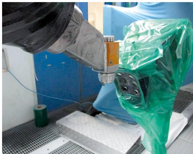
**Bild 2** > Messung am pneumatischen Zerstäuber (links).
