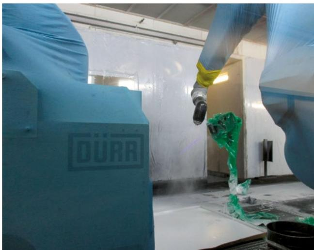
**Bild 1** > Versuche mithilfe einer optischen Messtechnologie am Hochrotationszerstäuber.
