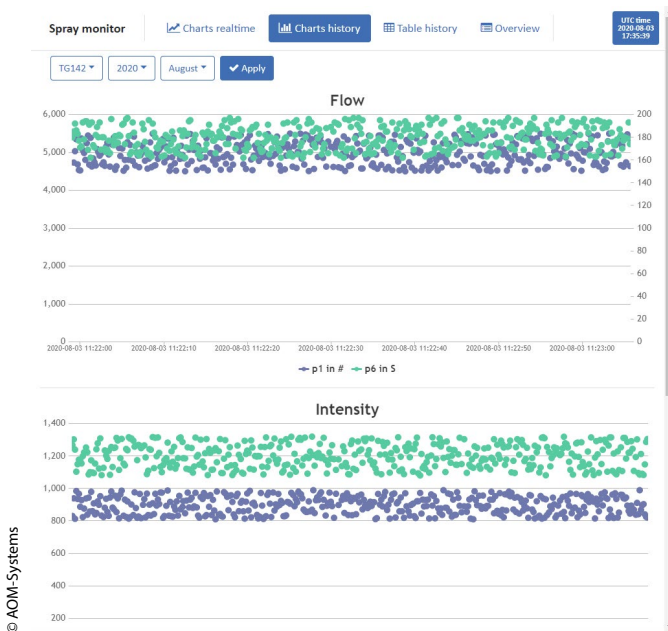
Beispielhafter Screenshot aus einer WebApp zur Überwachung einer Lackierung auf Basis der Flussrate und der Intensität. Alle Messpunkte liegen innerhalb der Toleranz (i.O.).
