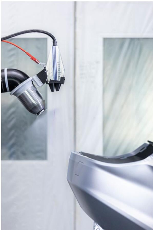
Inline-Messung direkt im Sprühprozess: Das System überwacht die Sprühstrahlqualität und erkennt Abweichungen in Echtzeit.
