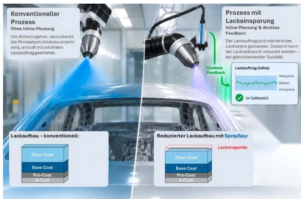
Die Gegenüberstellung zeigt den Unterschied zwischen dem konventioneller Prozess und dem Prozess mit Lackeinsparung.
