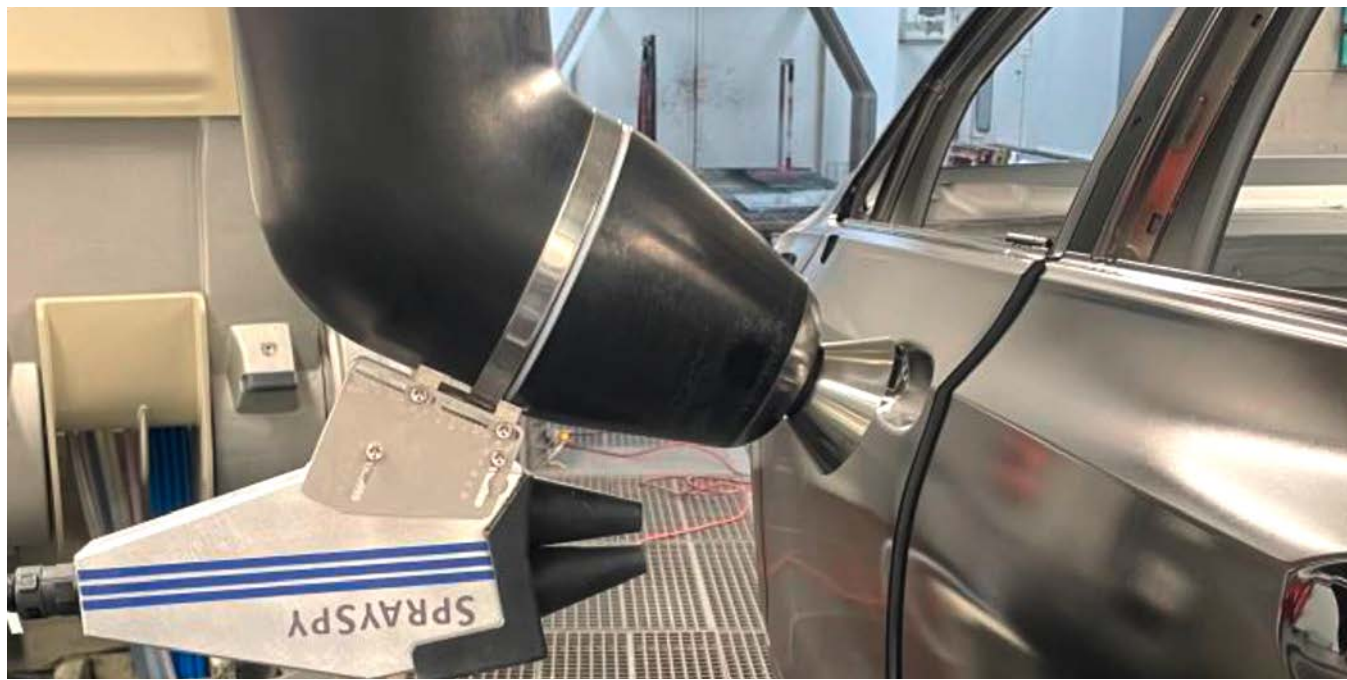
Das „SpraySpy“-Messsystem überwacht den Lack im Sprühstrahl und ermöglicht es, die finale Schichtdicke vorherzusagen. Foto: Volkswagen
